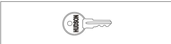
Cette clé sert à verrouiller/déverrouiller les compartiments à usage général à la base du pare-brise, à droite de la console et sur le tableau de commande latéral gauche.
