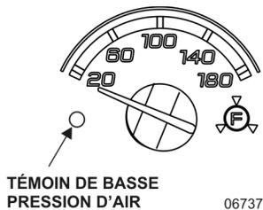
Indique la pression d'air en lbs/po<sup>2</sup> du circuit de freinage avant. La pression normale de fonctionnement se situe entre 122 et 140 lbs/po<sup>2</sup>.
