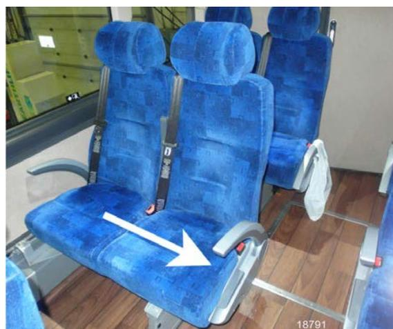
3. Faites pivoter le siège jusqu'à ce qu'il s'arrête (A) et repoussez vers la fenêtre pour verrouiller le mécanisme de rotation (B).
