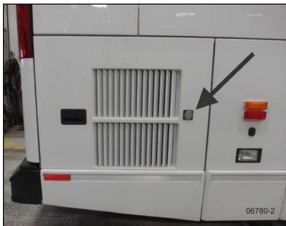
CONNECTEUR DU CHARGEUR DE BATTERIES
