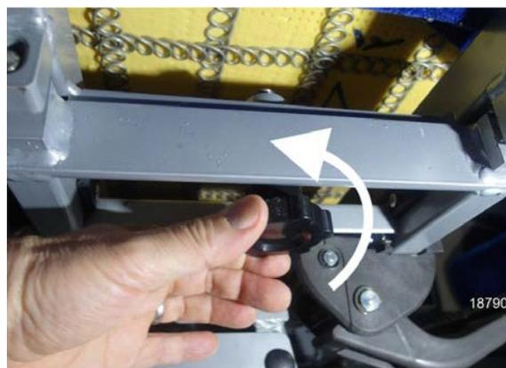
2. Tirez le siège vers l'allée pour déverrouiller le mécanisme de rotation.
