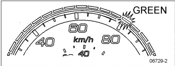
**FIGURE 31: THE CRUISE SET SPEED IS 80 KM/H**
