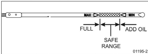
FIGURE 2: VOLVO D13 ENGINE OIL LEVEL DIPSTICK
