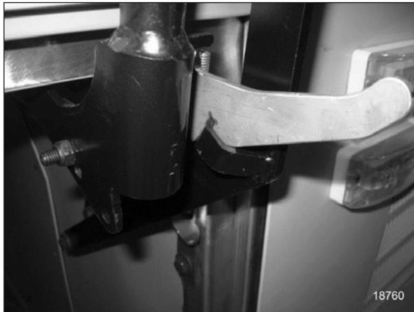
FIGURE 31: BAGGAGE DOOR LOCK AND LEVER
