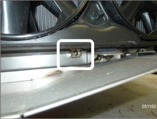
FIGURE 9: FAN SHROUD TOP & BOTTOM HOLD-DOWN SCREWS
