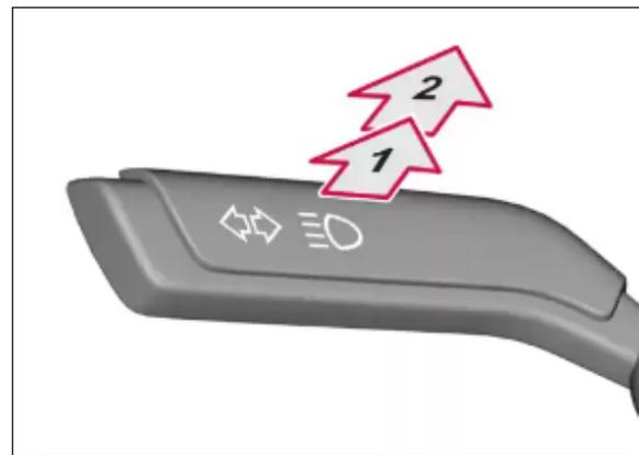
FIGURE 26: HIGH BEAM CONTROL
