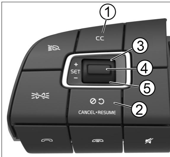
FIGURE 38: CRUISE CONTROL BUTTONS
