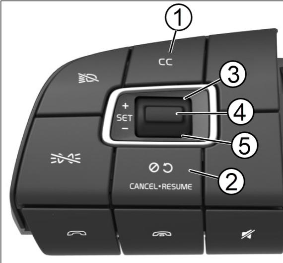
FIGURE 44: CRUISE CONTROL BUTTONS
