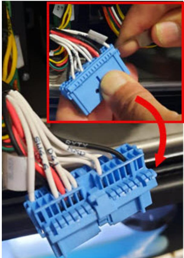
8. Insérer l'outil 683766 dans la cavité d'extraction à l'extrémité arrière de la broche **A36.JB :1**.
