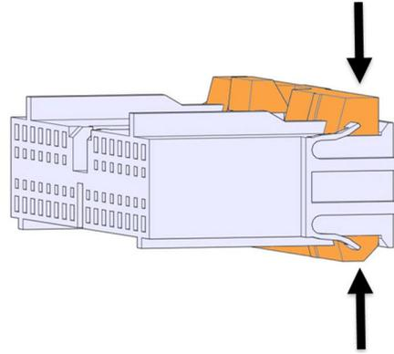
12. Rebrancher le connecteur **A36.JB** dans le module **A36**.
