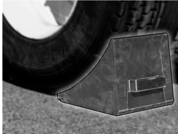
FIGURE 21 : CALER LES ROUES AVANT ET ARRIÈRE
