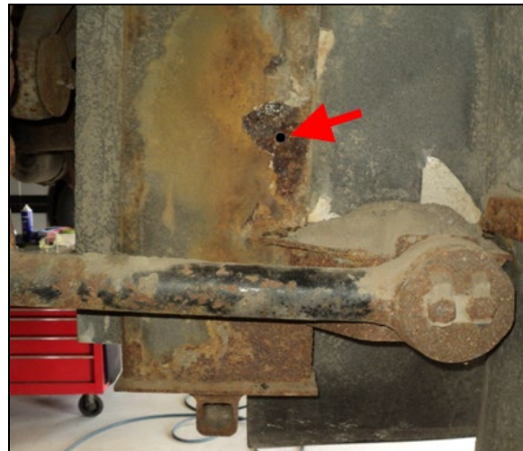
FIGURE 7: TROU PERCÉ DANS LE CHÂSSIS
