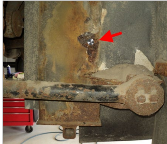
FIGURE 6: ZONE NETTOYÉE SUR LE CHÂSSIS
