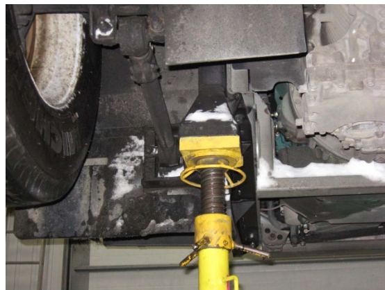
FIGURE 20: CHANDELLE AU SUPPORT DE LEVAGE - À L'ARRIÈRE DE L'ESSIEU AUXILIAIRE, CÔTÉ TROTTOIR
