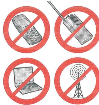
L'utilisation d'équipements électroniques à proximité du sélecteur de vitesses peut causer un mauvais fonctionnement du sélecteur
