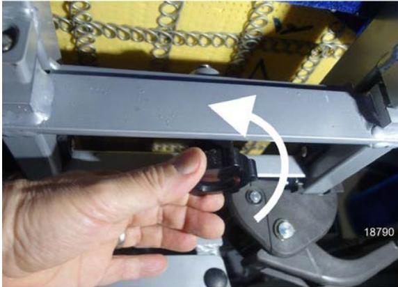
2. Tirez le siège vers l'allée pour déverrouiller le mécanisme de rotation.
