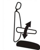
Pour relever ou abaisser l'avant du coussin du siège, tirer la poignée #3 vers le haut et pousser ou tirer sur le coussin
