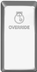
Basculer cet interrupteur sur le tableau de bord ou le bouton Delay Engine Stop du panneau de commande AFSS pour retarder de 15 secondes additionnelles l'arrêt automatique du moteur ainsi que la libération de l'agent d'extincteur chimique.
