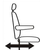
Pour régler la distance séparant le siège du tableau de bord, tirer la poignée #5 vers le haut et glisser le siège vers l'avant ou l'arrière.
