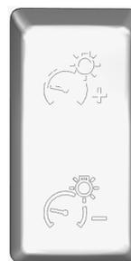
Ajuste l'intensité lumineuse des instruments et des interrupteurs.
