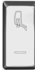
Basculer cet interrupteur pour désembuer, dégivrer et déglacer les rétroviseurs extérieurs ou les caméras du système de rétroviseurs par caméra vidéo.
