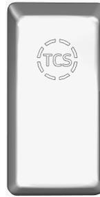
Dans certaines situations, il peut être utile de retarder l'intervention du dispositif antipatinage à l'accélération. Le mode Neige/Boue permet une puissance de moteur accrue et permet une rotation (patinage) des roues plus importantes durant le fonctionnement du dispositif TCS. Cette fonction est utile lorsqu'il est difficile de mettre le véhicule en mouvement comme sur une chaussée glacée par exemple.
