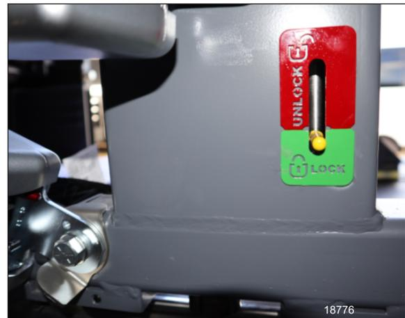
FIGURE 17: VERROUILLAGE SECONDAIRE
