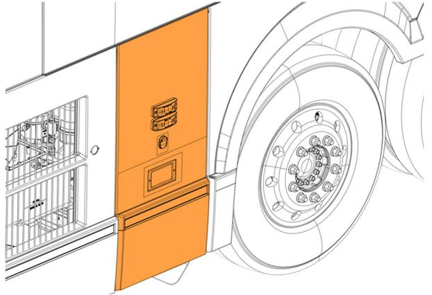
22. Allumer l'interrupteur de l'installation électrique principale.
