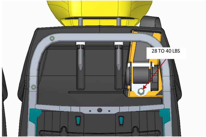
10. Installer le support de ceinture de sécurité sur la plaque latérale et centrale avec les boulons (1x par ceinture) et les écrous (1x par ceinture).
