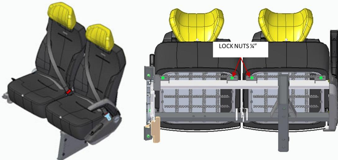
2. Retirer les boulons (1x par ceinture) et les écrous (1x par ceinture) et retirer le support de ceinture de sécurité de la plaque latérale et centrale.
