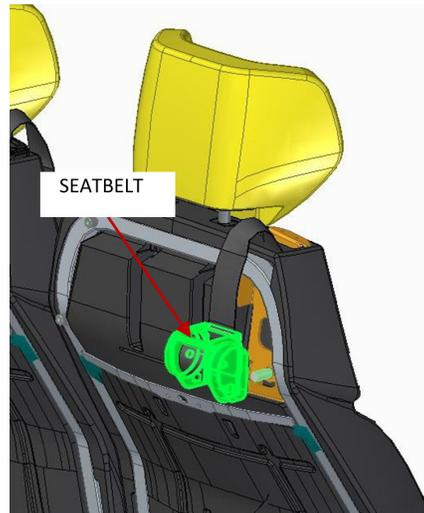
8. Installer la nouvelle ceinture de sécurité 867726 avec le nouvel écrou 5001734.
