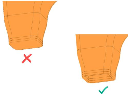
3. Couper le bout du conduit à 3/16 po de l'extrémité à l'aide d'une scie réciproque.
