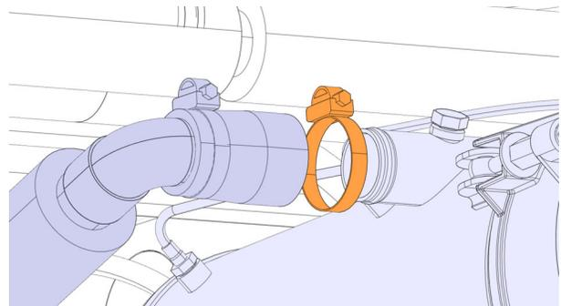
29. Réinstaller le tuyau d'échappement avec le collier de serrage en U.
