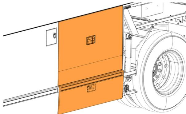
33. Percer un trou de  $\varnothing 3/8$ " dans le panneau du compartiment à bagages.
