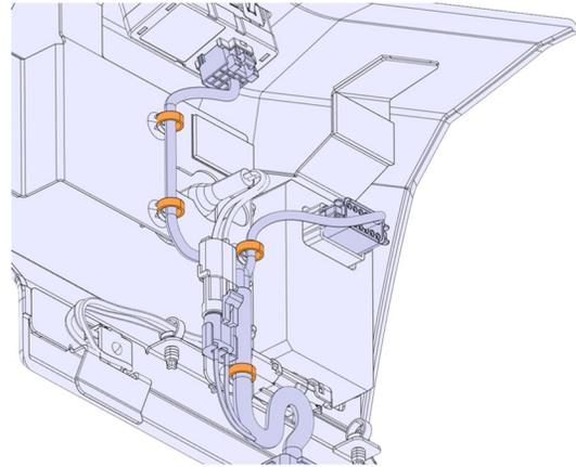
52. Débrancher l'ancien harnais de la console et le mettre au rebut.
