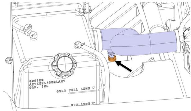
8. Retirer le capuchon de protection et raccorder l'extracteur de liquide de refroidissement au robinet de vidange du radiateur.
