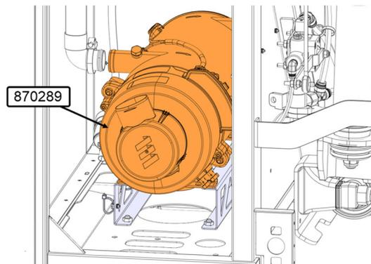
21. Fixer le nouveau préchauffeur 870289 avec les vis (4x) et les nouvelles rondelles 5001848 (4x) sur le support.
