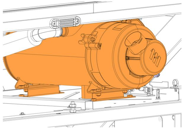
24. Fixer le nouvel ensemble du préchauffeur avec les vis (4x) et les nouvelles rondelles 5001848 (4x) sur la structure.
