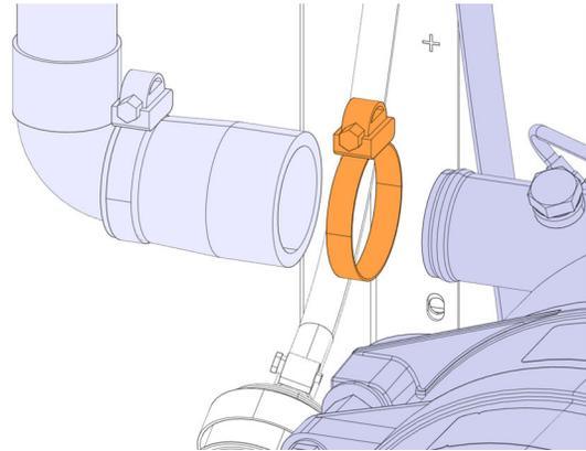
15. Dévisser le collier et débrancher le tuyau de sortie.
