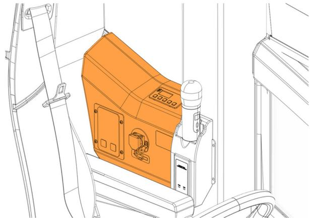
48. Débrancher le connecteur **C430** du harnais de la console du harnais principal de la boîte de jonction avant.
