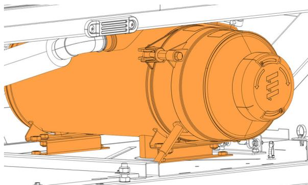
19. Dévisser les supports (2x) du préchauffeur, conserver les supports (2x), les vis (4x) et les rondelles (4x) et jeter les écrous (4x).
