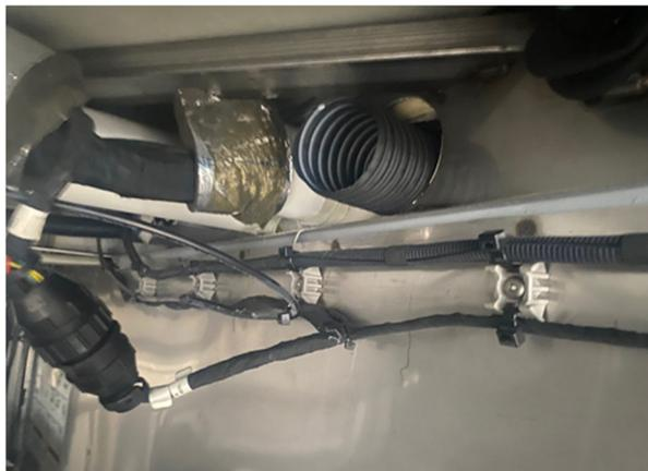
31. Connecter le tuyau 503031 à l'entrée d'air 870295 du préchauffeur avec le collier 504024.
