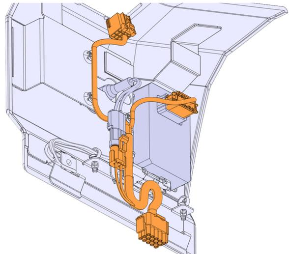
53. Installer le nouveau boîtier 870253 sur la console dans le trou pour la minuterie.
