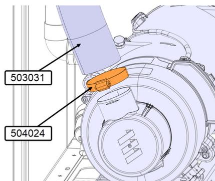
32. Fixer le tuyau 503031 sur le tuyau existant à l'aide des espaceurs rotatif 504751 (3x) et des attache-câbles 504016 (6x).
