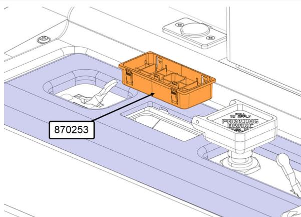
47. Installer la nouvelle minuterie 870252 sur le couvercle 870253 de la console gauche.
