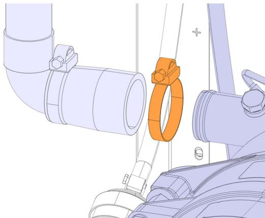
26. Réinstaller le tuyau d'échappement avec le collier de serrage en U.
