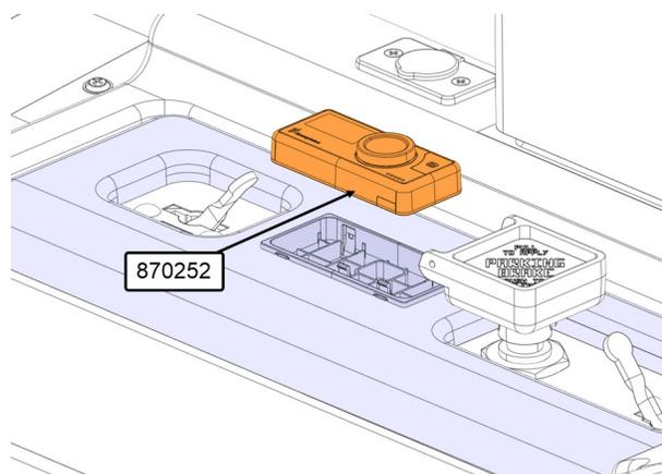
48. Connecter le connecteur **C\_A11A** de l'appareil de chauffage au harnais CAN 0610673 de la minuterie 870252.
