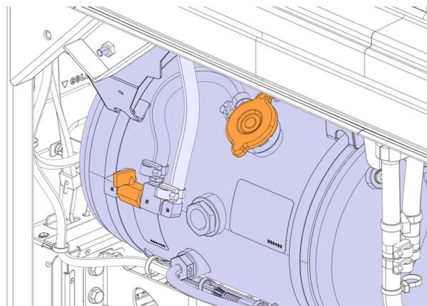
52. Brancher la machine de récupération du liquide de refroidissement sur le raccord.
