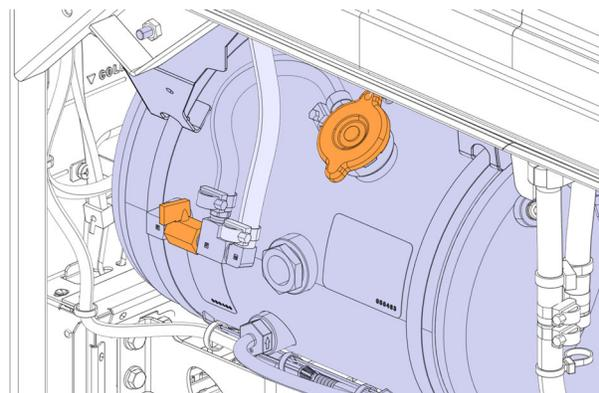
6. Localiser le robinet de vidange sur le tuyau d'eau du radiateur.
