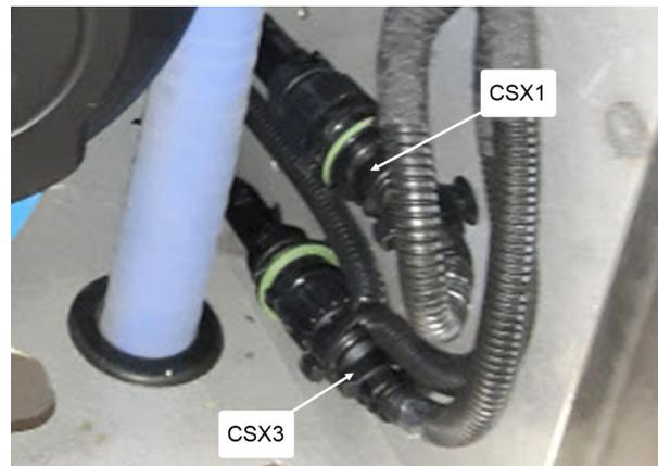
13. Débrancher les tuyaux de carburant et jeter les rondelles (4x) et les boulons banjo (2x).
