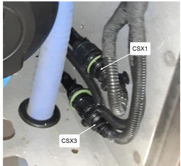
36. Installer le harnais CAN 0610673 du préchauffeur à la minuterie en suivant le routage. Vous devez commencer par l'arrière du véhicule jusqu'à la boîte de jonction avant.
