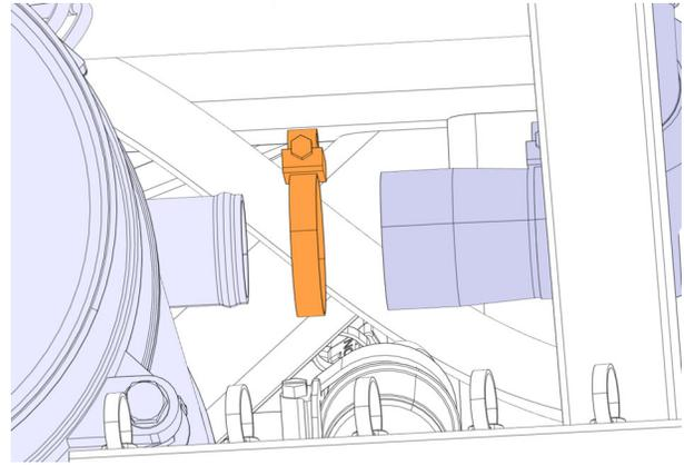
17. Dévisser l'assemblage du chauffage, conserver la vis (4x) et jeter la rondelle (4x).
