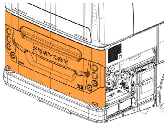
61. Fermer la porte du compresseur. La procédure est terminée, aucune autre action n'est requise.
