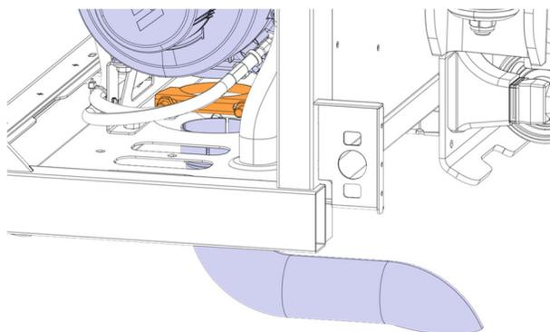
27. Reconnecter les tuyaux de carburant avec les nouvelles rondelles (4x) et les boulons banjo (2x) (inclus avec le chauffage).
