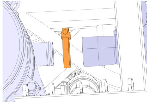
27. Connecter le tuyau d'entrée avec le collier de serrage sur le nouveau préchauffeur.
