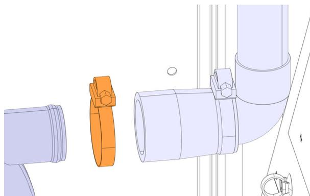
24. Connecter le tuyau d'entrée avec le collier de serrage sur le nouveau préchauffeur.
