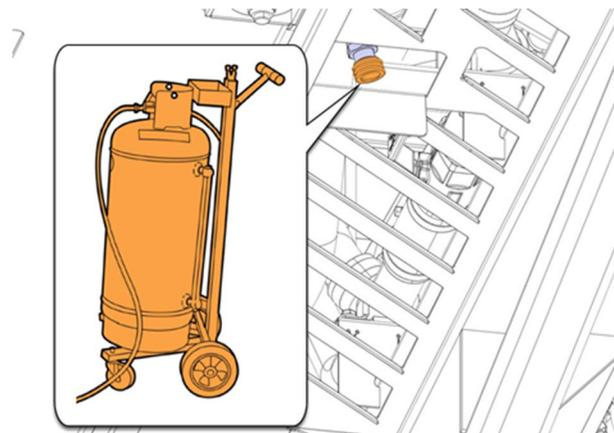
64. Fermer la soupape de sécurité du réservoir d'expansion.
