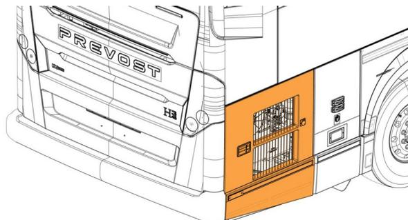
2. Soulever le levier de déverrouillage pour déverrouiller la porte du compartiment moteur.
