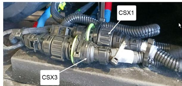
47. Installer le harnais CAN 0610673 du préchauffeur à la minuterie en suivant le routage. Vous devez commencer par l'arrière du véhicule jusqu'à la boîte de jonction avant.
