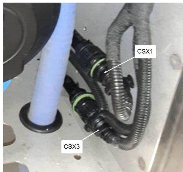
36. Installer le harnais CAN 0610673 du préchauffeur à la minuterie en suivant le routage. Vous devez commencer par l'arrière du véhicule jusqu'à la boîte de jonction avant.
