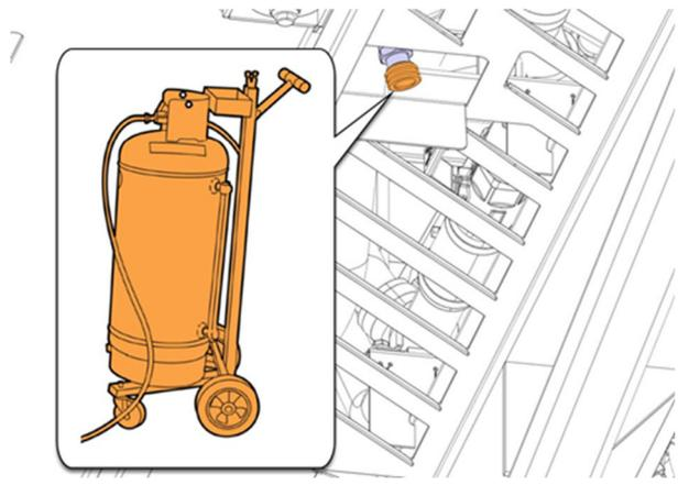
67. Fermer la soupape de sécurité du réservoir d'expansion.
