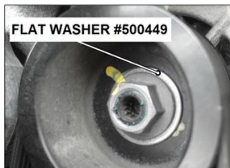
Dévisser l'écrou de fixation de la poulie d'alternateur et retirer la poulie de l'alternateur.
