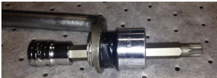
CLÉ OFFSET 7/8 ÉQUIPÉE D'UNE DOUILLE 7/8 ET EMBOUT 10mm CANNELÉ À 12 POINTS
