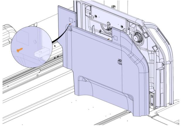
7. Réinstaller la tablette avec les écrous (2x) et les rondelles (2x).
