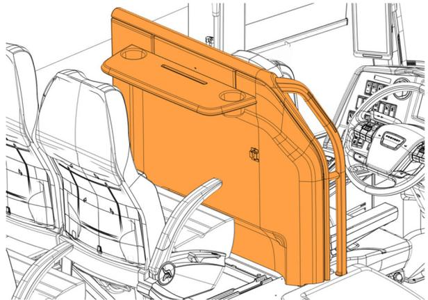
2. Retirer les écrous (2x) et les rondelles (2x) et retirer la tablette.
