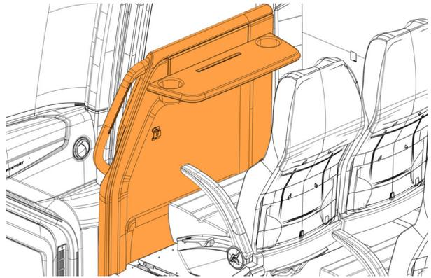
2. Retirer les écrous (2x) et les rondelles (2x) et retirer la tablette.
