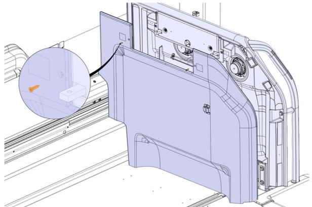
4. Glisser la tôle 3202286 entre le plancher et la structure du panneau modestie.
