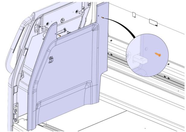
4. Glisser la tôle 3202287 entre le plancher et la structure du panneau modestie.
