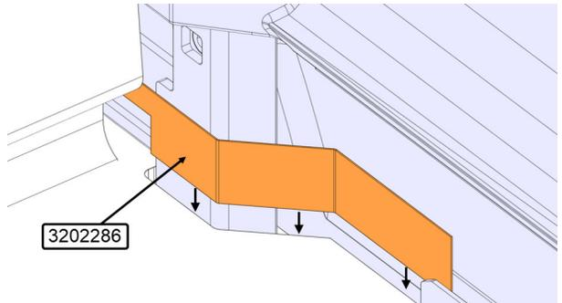
5. Appliquer le scellant 684685 sur le joint entre le panneau modestie et le plancher et le rail du siège.
