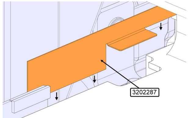
5. Appliquer le scellant 684685 sur le joint entre le panneau modestie et le plancher et le rail du siège.
