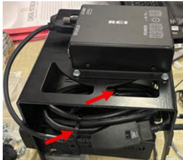
49. Couper le connecteur à 2 broches **A** du préamplificateur 7775435, pour le remplacer par un connecteur à 4 broches.
