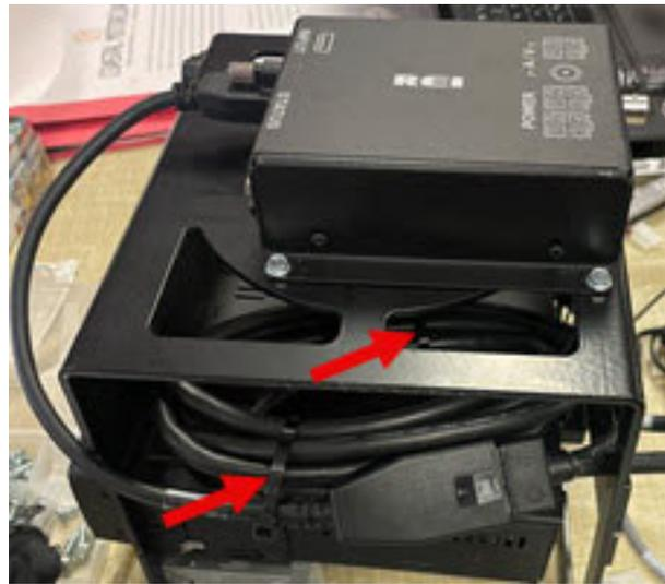
24. Couper le connecteur à 2 broches A du préamplificateur 7775435, pour le remplacer par un connecteur à 4 broches.
