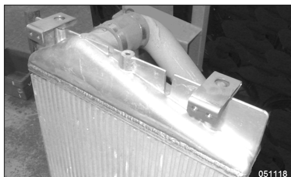
FIGURE 65: ÉQUERRES DE SUPPORT ET TUYAU SUPÉRIEUR DU REFROIDISSEUR D'AIR (CAC)
