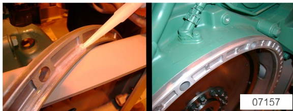
FIGURE 11: INSTALLATION DE L'ENTRETOISE D'ESPACEMENT
