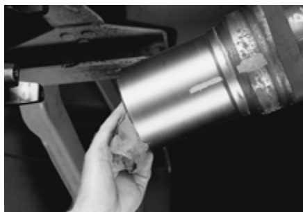
FIGURE 23: NETTOYER LA GRAISSE DU MANCHON CANNELÉ
