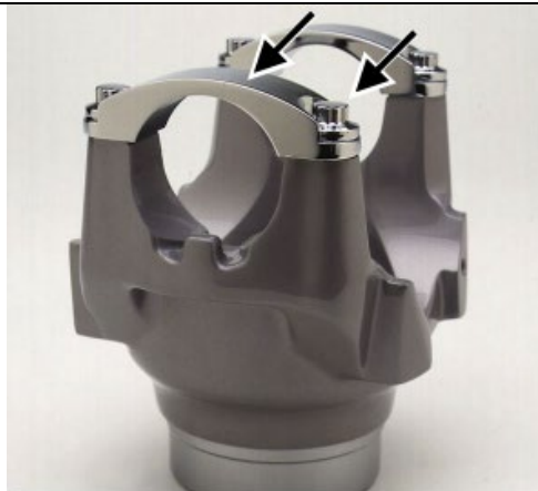
FIGURE 2: DEMI-COLLIERS DE RETENUE POUR JOINT UNIVERSEL FORMÉE À FROID ET BOULONS TELS QU'UTILISÉS SUR LES VÉHICULES PREVOST
