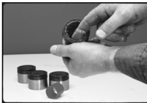
FIGURE 28: GRAISSAGE DES COUPELLES DE ROULEMENT
