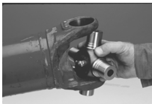
FIGURE 29: POSITIONNER LE CORPS DU JOINT UNIVERSEL À L'INTÉRIEUR DE LA FOURCHE AVEC L'EMBOUT DE GRAISSAGE VERS L'INTÉRIEUR POINTANT VERS LE TUBE.
