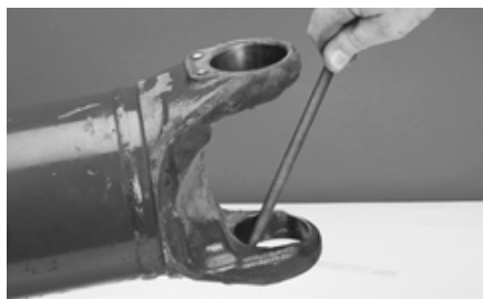
FIGURE 21: LES EFFRITEMENTS DE MÉTAL OU DES ENCAVURES PEUVENT ÊTRE ENLEVÉS AVEC UNE LIME À DENTS FINES ET/OU UNE TOILE ÉMERI.
