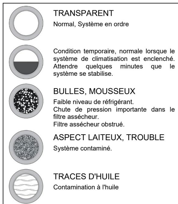
FIGURE 66 : CONDITIONS POUVANT ÊTRE OBSERVÉES DANS L'INDICATEUR D'HUMIDITÉ
