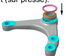
5. Appliquer une graisse au lithium de bonne qualité (n° 680752) sur la bague d'appui et le soufflet anti-poussière.
