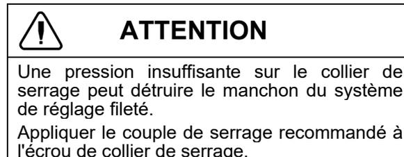
Un réglage précis de la longueur de la barre de direction doit être obtenu exclusivement en faisant tourner le manchon du dispositif de réglage.
