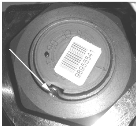
FIGURE 15: MARQUE DE POINÇON SUR L'ÉCROU DE DE L'ARBRE DE SORTIE
