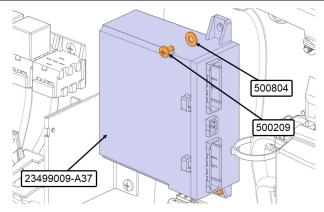
7. Installer le câblage du module A37 0600193 à l'intérieur de la boîte de jonction avant (voir l'image).
