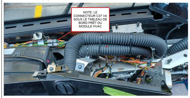
Note : Le câblage est livré avec 2 résistances de terminaison Res37A et Res37B. Deux résistances de 120 ohms sont connectées en parallèle pour équilibrer le Datalink DL100 à 60 ohms au total. Si l'appareil du client comprend des résistances de terminaison, certaines résistances doivent être supprimées. Le nombre de résistances sur le Datalink DL100 doit toujours être de deux résistances au total.
