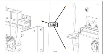
6. Installer le nouveau module 23499009-A37 avec les vis 500209 (3x) et les rondelles 500804 (3x).
