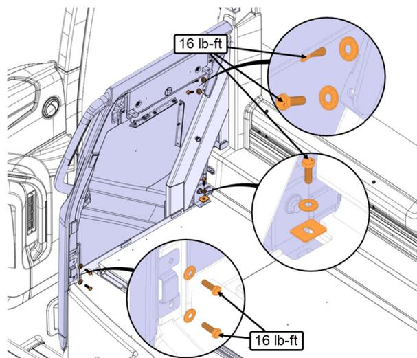
35. Fixer le bas de la main courante avec la vis et la rondelle.
