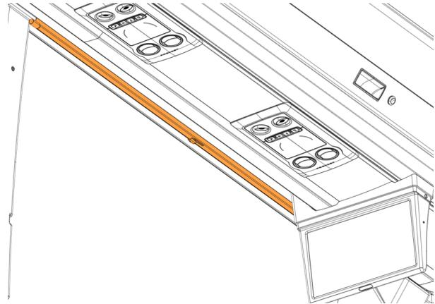
2. Retirer les vis (3x) et la moulure inférieure de la fenêtre.
