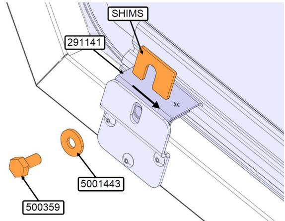
15. Appliquer un couple de serrage de 27.5 lb-pi aux vis situées au bas de la fenêtre.
