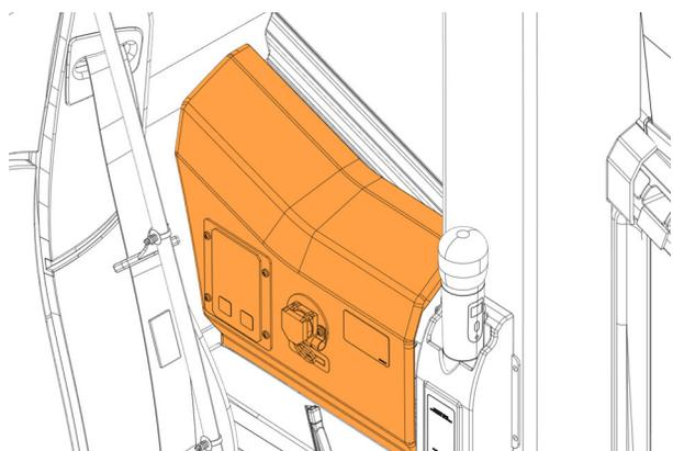
25. Réinstaller la moulure de la fenêtre du conducteur.
