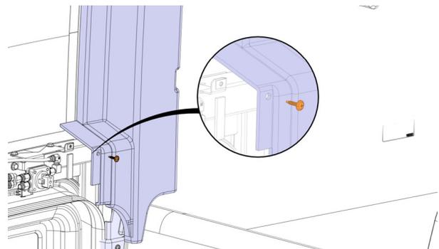
44. Réinstaller la moulure de la porte d'entrée supérieure.
