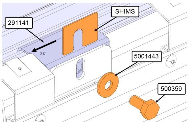
20. Appliquer un couple de serrage de 27.5 lb-pi aux vis situées au bas de la fenêtre.
