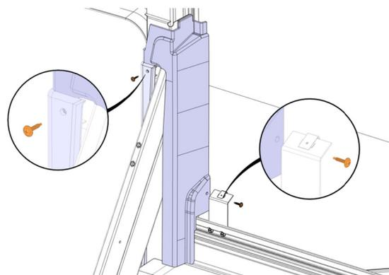
31. Réinstaller la moulure inférieure de la fenêtre avec les vis (4x).
