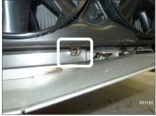
FIGURE 11: FAN SHROUD TOP & BOTTOM HOLD-DOWN SCREWS
