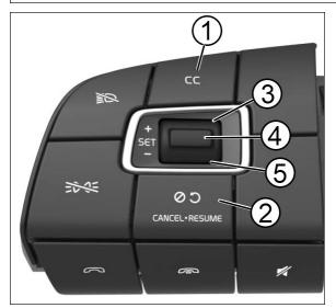
FIGURE 39: CRUISE CONTROL BUTTONS
