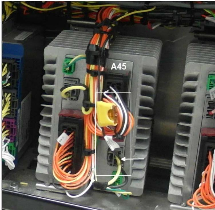
**A45 MODULE & ELD GATEWAY MODULE CONNECTION**
