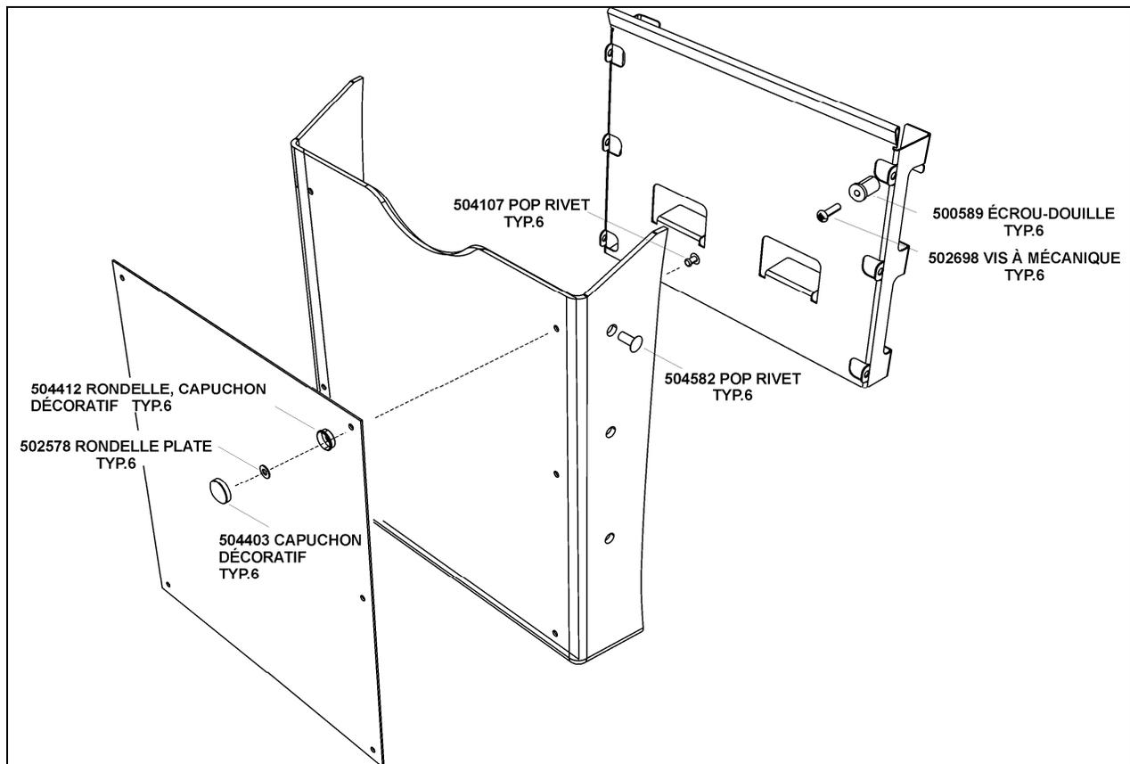
1. Retirer l'ensemble plaque et décalque actuellement en place sur le véhicule. Camoufler les 2 trous du haut à l'aide de 2 rivets #406528.
