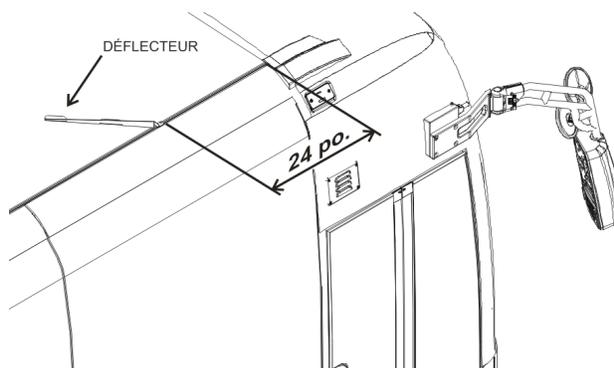
2. Nettoyer la zone de collage du toit ainsi que le déflecteur à l'aide d'alcool isopropylique. Laisser sécher avant d'appliquer l'adhésif.
