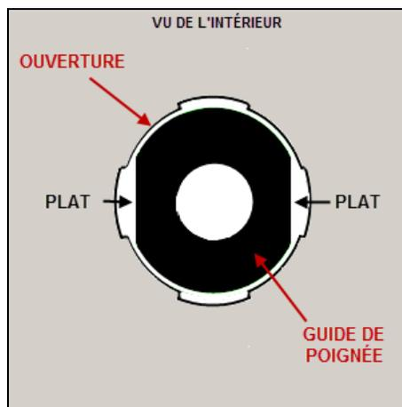
8. Retirer la pellicule protectrice des deux bandes adhésives à l'endos de la plaque de support (280781) et glisser la plaque dans le logement de serrure en insérant le guide dans l'ouverture de la plaque. S'assurer que les côtés plats de la plaque et du guide sont installés de gauche à droite tel qu'illustré et presser légèrement pour permettre une bonne adhésion de la plaque sur la porte.
