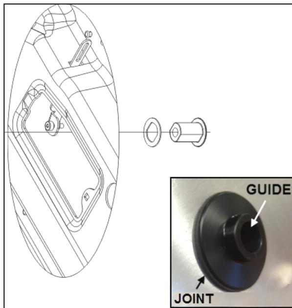
12. Installer un autre joint d'étanchéité de guide (280477) par l'intérieur et fixer le guide à la porte à l'aide de la rondelle de blocage (5000350) et de l'écrou M20 (5000351) fournis.
