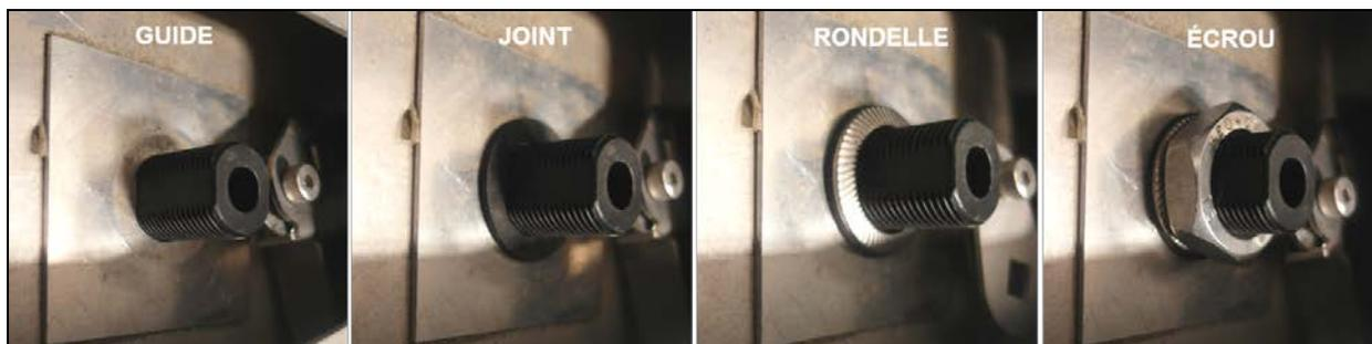
13. Glisser le joint torique (507016) le long de la tige de la poignée (280473) (le joint doit reposer dans la rainure de la tige) et appliquer une petite quantité de graisse (compatible avec le caoutchouc) sur la circonférence du joint. Insérer la poignée dans le guide en s'assurant que la poignée est installée à la verticale.
