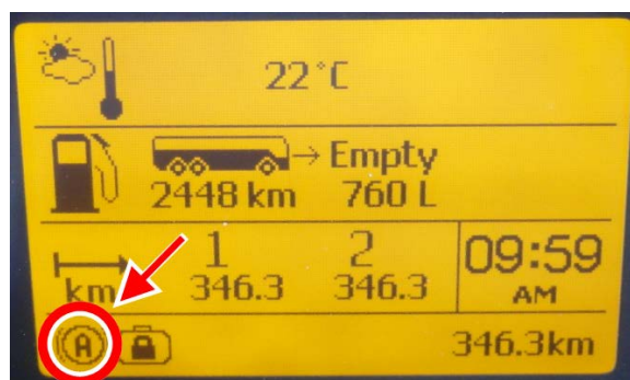
FIGURE 42 : PROCÉDURE TERMINÉE AVEC SUCCÈS, LE PICTOGRAMME (A) S'AFFICHE À LA LIGNE D'ÉTAT
