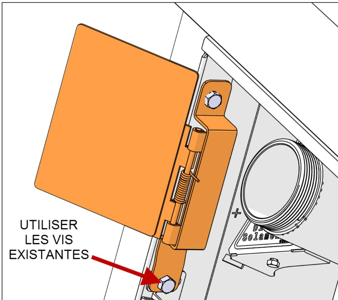
FIGURE 2 : MODÈLE X3 AVEC SERRURE INSTALLATION DE LA TRAPPE
