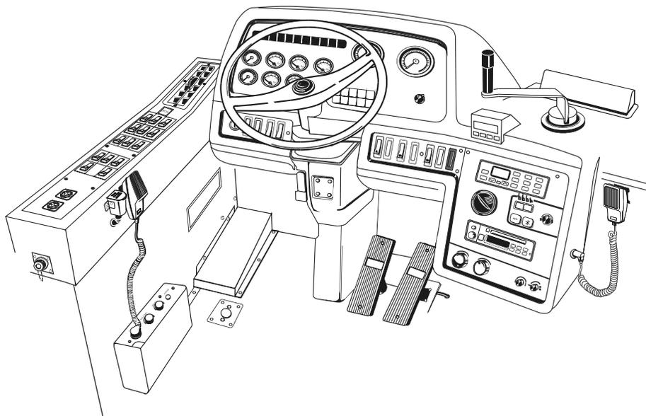
2. Déverrouiller le mécanisme de réglage télescopique de la colonne de direction, tirer sur le volant jusqu'à la position maximale puis verrouiller de nouveau le mécanisme.
