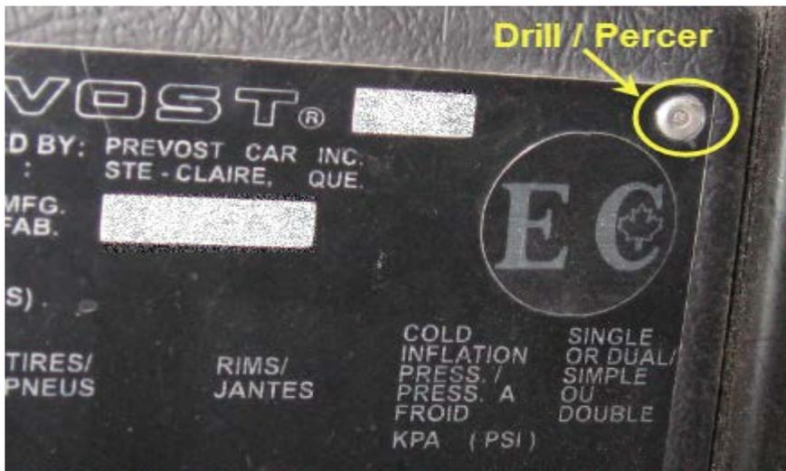
Fig.7 Rivets à retirer (4x)
