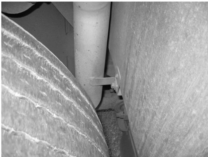
3. Voici la bonne position. La distance entre le tube et le pneu devrait être d'environ 50mm (2 po).
