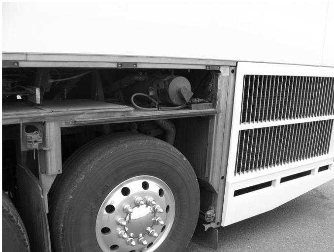
2. Vérifier le dégagement entre le tube et le pneu.
