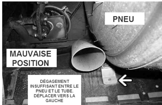
5. Soulever le véhicule et enlever la roue gauche de l'essieu auxiliaire.
