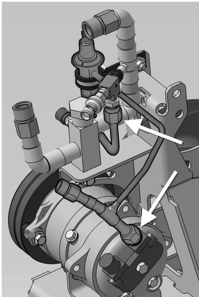
10. Connecter le boyau haute pression au raccord fileté sur le tube de dérivation.
