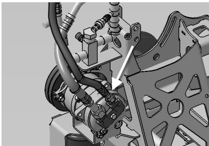
4. Démontez la sonde. Garder pour réassemblage.
