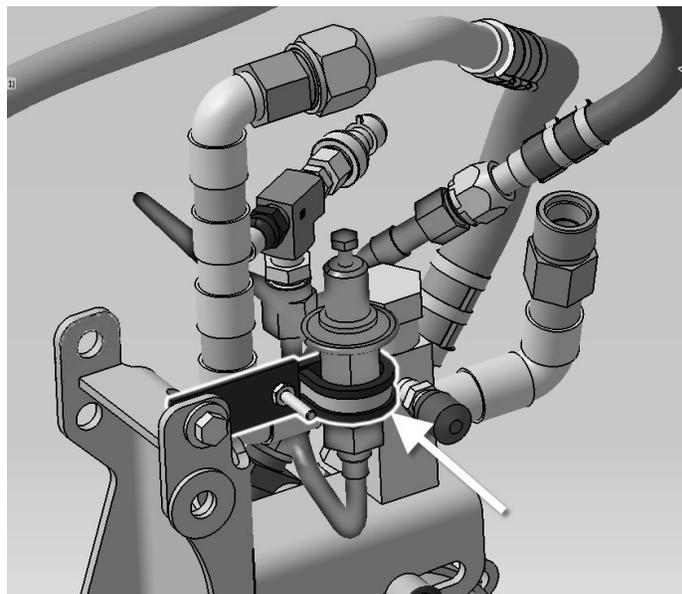
13. Remplir le système de gaz réfrigérant et tester le fonctionnement du système d'air climatisé.
