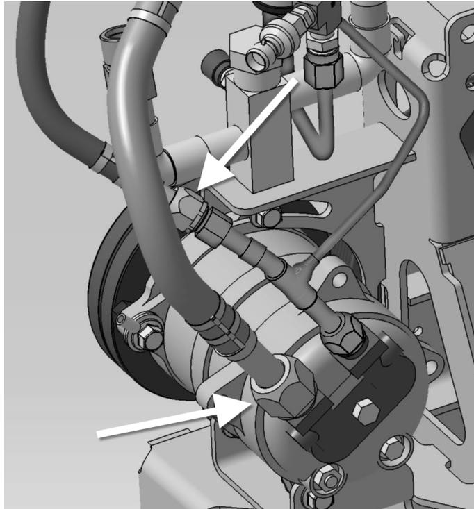
12. Fixer la valve de dérivation au support d'alternateur avec l'attache en P et la quincaillerie fournie.
