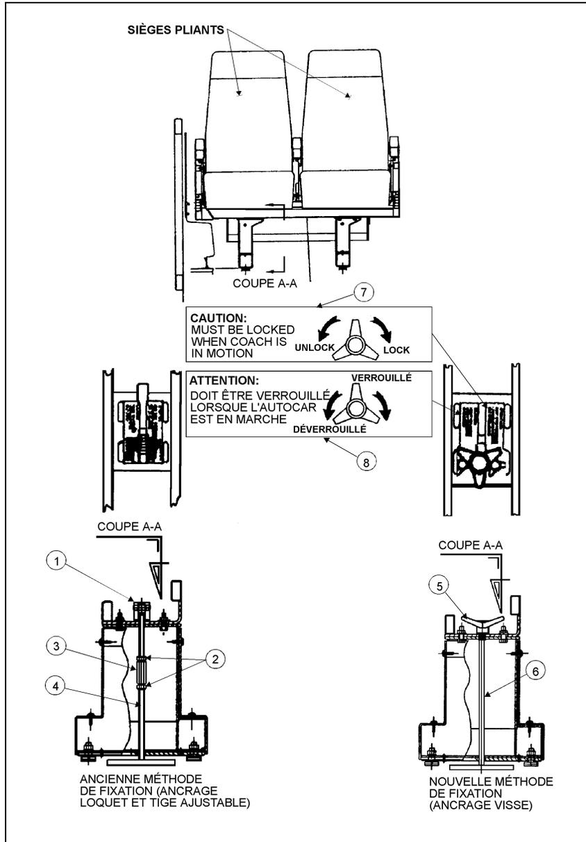
FIGURE 1: MODIFICATION DE L'ANCRAGE DES SIÈGES PLIANTS
