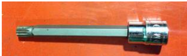
MÉTRIQUE 10mm 12-POINTS SPLINE DRIVE ALLONGÉ (CARLYLE SLTS3810M disponible de NAPA )
