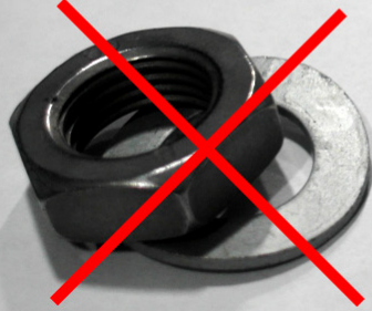
FIGURE 1: ÉCROU DE MONTAGE DE LA POULIE – NE PAS UTILISER L'ÉCROU STANDARD ET LA RONDELLE À RESSORT QUI PEUVENT ÊTRE FOURNIS AVEC L'ALTERNATEUR. UN ÉCROU À BRIDE DOIT ÊTRE UTILISÉ
