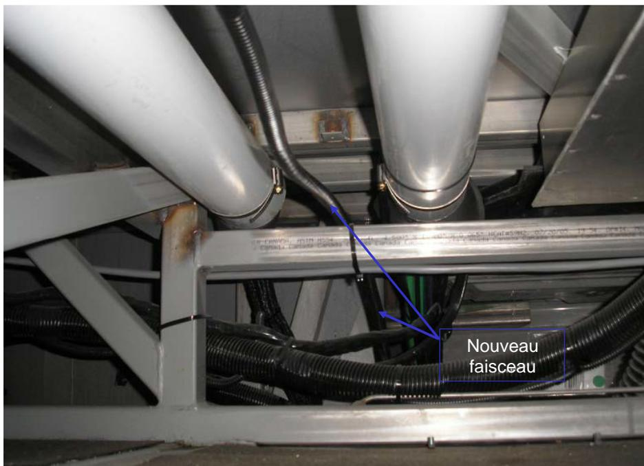
Faites passer le nouveau faisceau au dessus de la traverse et dans le compartiment du pneu de secours
