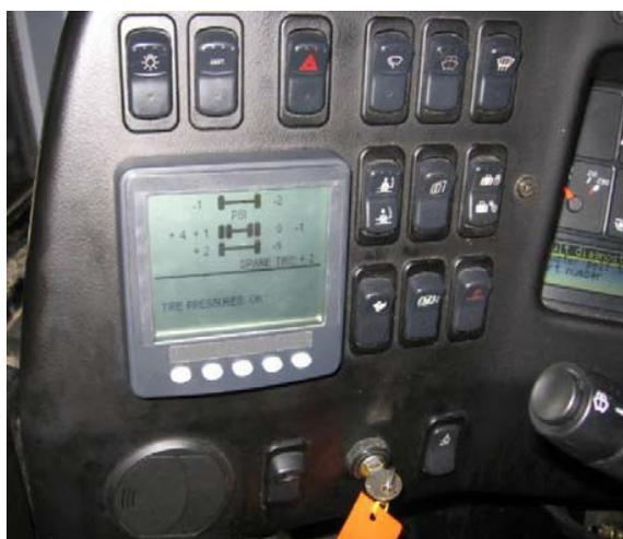
Avant de passer au boîtier de jonction, mettez le contact et testez tous les commutateurs pour vérifier qu'ils fonctionnent convenablement.
