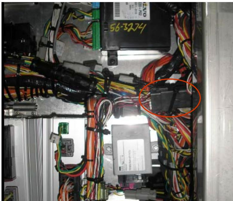
Depuis le compartiment du pneu de secours, acheminez le C-233 à travers le compartiment de conduite jusqu'au FJB, branchez-le et acheminez le faisceau en le fixant avec des attaches de câbles comme indiqué.
