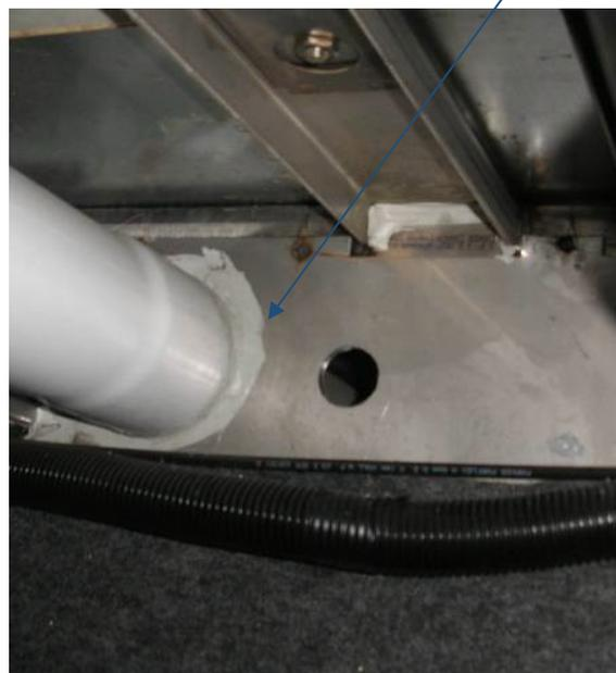
Mesurez d'abord une distance de 2"1/2 à partir de l'axe du tube PVC existant, forez un avant-trou de guidage de 1/8" dans la cloison puis un trou de 1"1/8 à l'aide d'une scie trépan. C'est l'endroit où le faisceau doit être acheminé vers les antennes arrière.
