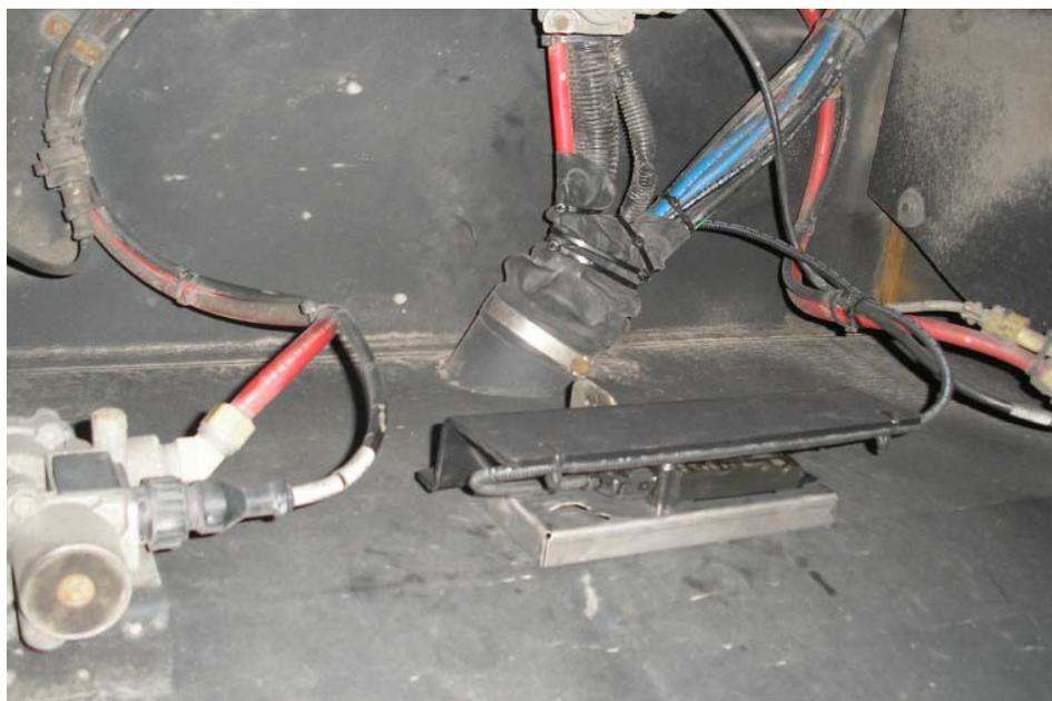
Depuis le compartiment du pneu de secours, acheminez le C100 à travers le tube jusqu'à la zone de l'essieu avant. Montez le capteur et sa protection, acheminez le faisceau et fixez-le avec des attaches de câbles comme indiqué.
