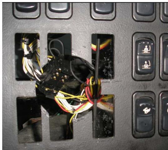
À l'aide d'une scie à découper de 2"3/4, découpez soigneusement l'orifice d'encastrement du moniteur, \*la faible épaisseur du plastique permet de le découper sans effort important
