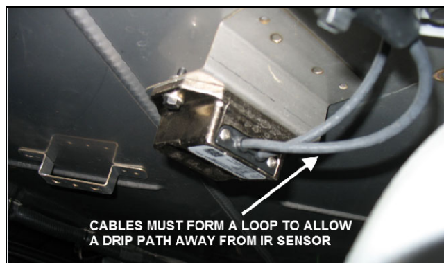
FIGURE 34 : LES FILS DOIVENT FORMER UNE COURBE VERS LE BAS
