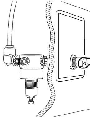
2. Marquez la position du boulon sur l'ajustement du tendeur. Dé-serrer pour relâcher la tension sur les courroies.
