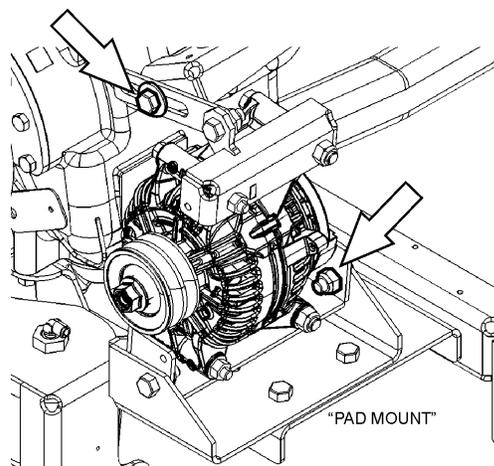
5. Installer la portion supérieure du garde #068419 avec la quincaillerie existante sur le support supérieur du tendeur
