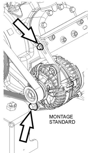
4. Alternateur « pad mount », retirer le boulon avant du pivot et le conserver pour ré assemblage.
