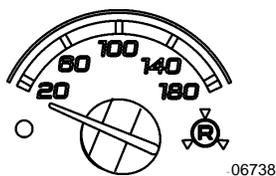
**Pression d'air du système de freinage arrière (primaire) (psi)**
