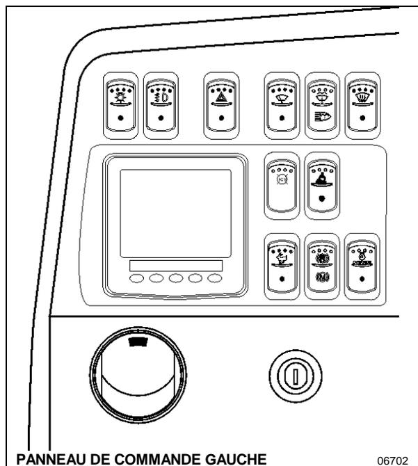
Le panneau de commande gauche du tableau de bord comprend les interrupteurs de commande pour la conduite de l'autocar. Il comprend également le commutateur d'allumage et un registre d'air réglable pour le conducteur.
