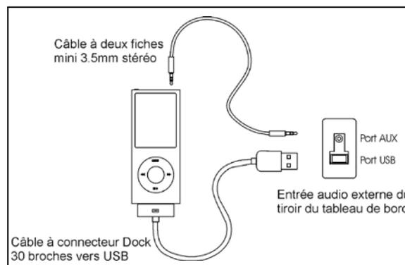
**CONNEXION D'UN IPOD AVEC DEUX CÂBLES SÉPARÉS**
