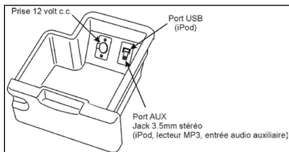
**CONNEXION D'ENTRÉE AUDIO EXTERNE DANS LE TIROIR INFÉRIEUR DU TABLEAU DE BORD**
