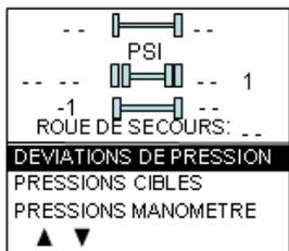
Tel qu'illustré, les lectures de pression apparaissent en remplacement des tirets à mesure que l'afficheur du TPMS reçoit les données du récepteur du TPMS. Cela peut prendre 1 minute avant que toutes les lectures de pression parviennent à l'afficheur puisque les capteurs transmettent à intervalle de 1 minute.
