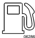
06286 Ce témoin s'allume lorsqu'il reste environ 45 litres (12 gallons US.) dans le réservoir. Il est recommandé de ne pas franchir plus de 100 kilomètres (62 milles) alors que le témoin est allumé. Faire le plein dès que possible.
