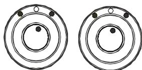
Tourner le bouton gauche pour l'ajustement du miroir plat du rétroviseur et vers la droite pour l'ajustement du miroir de type convexe. Pivoter ensuite la commande dans le sens approprié afin d'orienter le rétroviseur à l'angle désiré.
