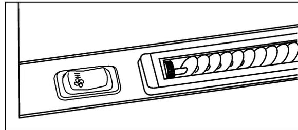
NAVIGATOR'S AIR REGISTER & FAN SPEED CONTROL SWITCH
