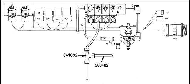
FIGURE 2: LOCATION OF MANIFOLD BEHIND DASHBOARD FININSHING PANEL
