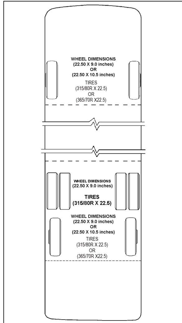
**FIGURE 2: WHEEL ARRANGEMENT** 13037
