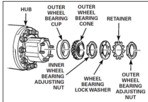
FIGURE 9: DRIVE AXLE WHEEL HUB
