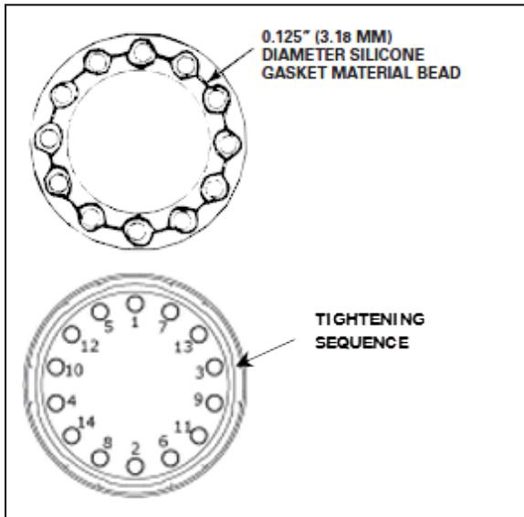
FIGURE 10: AXLE FLANGE TIGHTENING SEQUENCE
