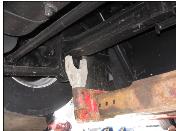
LEVAGE PAR L'ESSIEU AVANT
