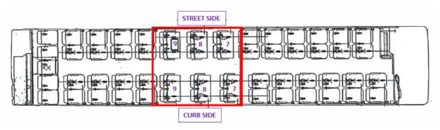
VEHICLE SEAT CONFIGURATION SHOWING FLIP-UP SEATS POSITION
