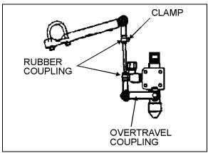
FIGURE 24: FRONT HEIGHT CONTROL VALVE
