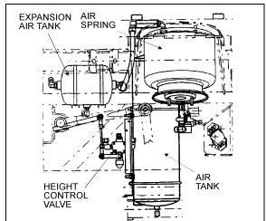
FIGURE 22: HEIGHT CONTROL VALVE LOCATION
