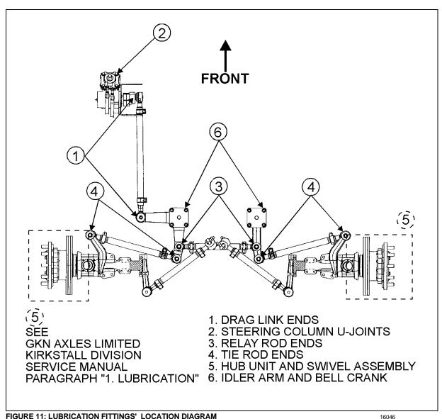
FIGURE 11. LUBRICATION FITTINGS LOCATION DIAGRAM
