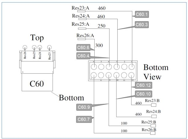
FIGURE 1: 0600179 RESISTOR HARNESS (CONNECTOR C60)
