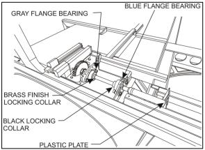
FIGURE 15: MECHANICAL COMPONENTS (TYPICAL)
