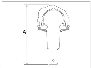
FIGURE 32: UPPER A-ARM BALL JOINT 16116
