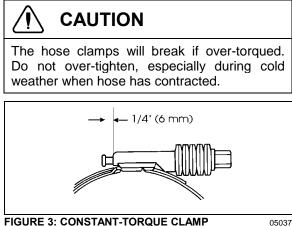
FIGURE 3: CONSTANT-TORQUE CLAMP
