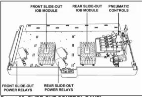
FIGURE 38: SLIDE-OUT CONTROL PANEL
