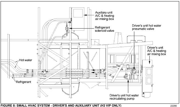
FIGURE 8: SMALL HVAC SYSTEM - DRIVER'S AND AUXILIARY UNIT (H3 VIP ONLY)
