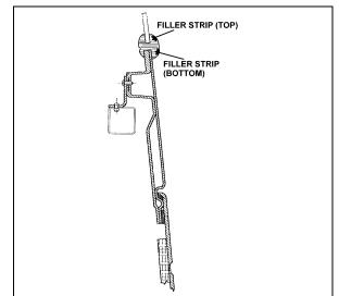
FIGURE 49: WINDSHIELD INSTALLATION SIDE VIEW 8099
