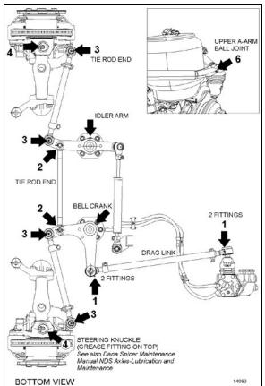
FIGURE 28: LUBRICATION FITTINGS LOCATION
