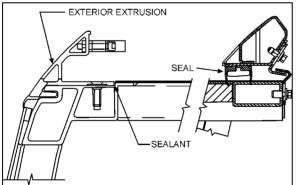
FIGURE 9: EXTERIOR EXTRUSION
