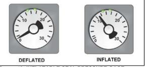
FIGURE 42: INFLATABLE SEAL PRESSURE GAGE
