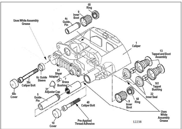
FIGURE 22: BRAKE COMPONENTS
