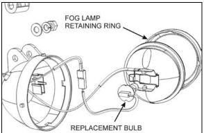
FIGURE 66: FOG LIGHT EXPLODED VIEW
