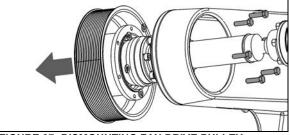
FIGURE 37: DISMOUNTING FAN DRIVE PULLEY 05123C
