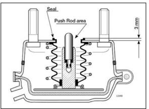
FIGURE 31: DRIVE AXLE BRAKE AIR CHAMBER
