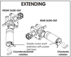
FIGURE 43: SLIDE-OUT MOTOR ROTATION
