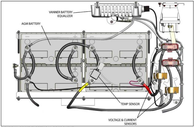
FIGURE 33: PRIME ELECTRICAL COMPONENT
