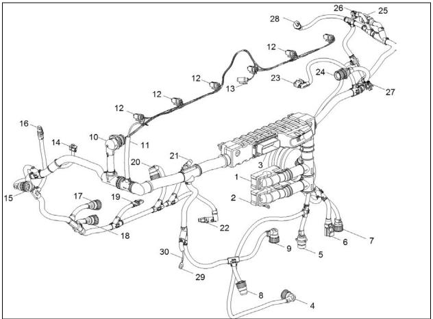
FIGURE 1: D13H ENGINE HARNESS
