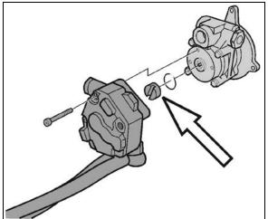
FIGURE 7: FUEL PUMP DRIVE AXLE
