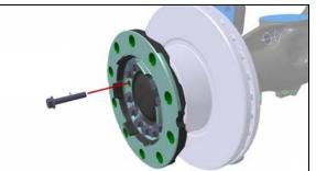
FIGURE 23: HUB FLANGE HEX CAP SCREW
