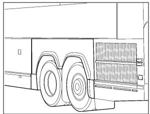
FIGURE 21: L.H. SIDE REAR FENDER
