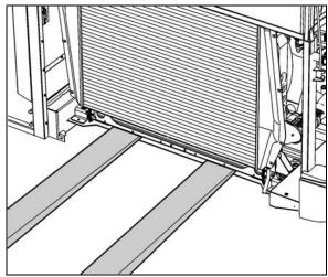
FIGURE 31: POSITIONING FORKLIFT
