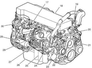
FIGURE 1: D13H ENGINE OVERVIEW, TURBO SIDE
