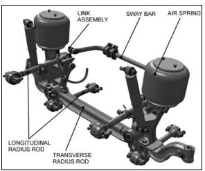
FIGURE 1: FRONT I-BEAM AXLE SUSPENSION 16105
