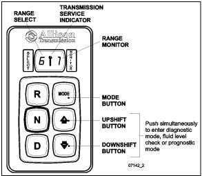
FIGURE 2: ALLISON PUSHBUTTON SHIFT SELECTOR
