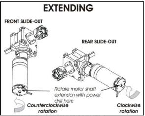
FIGURE 43: SLIDE-OUT MOTOR ROTATION
