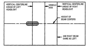
FIGURE 48: UPPER BEAM HIGH-INTENSITY ZONE PROPER LOCATION ON SCREEN 06503
