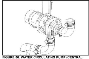
FIGURE 56: WATER CIRCULATING PUMP (CENTRAL A/C)
