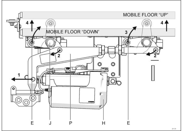
FIGURE 46: FLUSH FLOOR LIFTING
