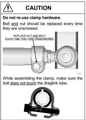
FIGURE 29: I-BEAM FRONT AXLE DRAG LINK
