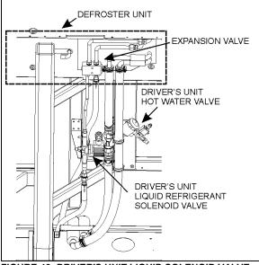
FIGURE 46: DRIVER'S UNIT LIQUID SOLENOID VALVE
