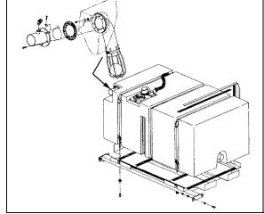
FIGURE 12: 208 US GALLONS FUEL TANK
