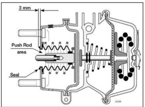
FIGURE 30: DRIVE AXLE BRAKE AIR CHAMBER
