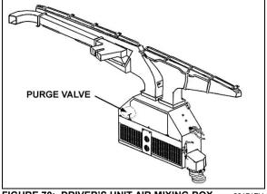
FIGURE 70: DRIVER'S UNIT AIR MIXING BOX 22171PV
