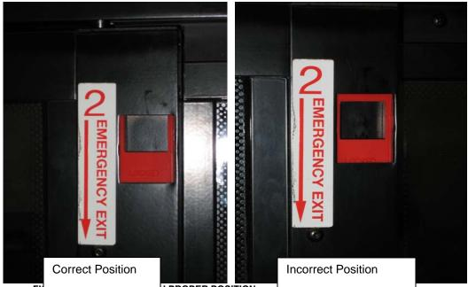
FIGURE 43: RELEASE LATCH PROPER POSITION
