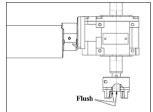
FIGURE 21: CLAMPING HUB POSITION ON GEARBOX SHAFT
