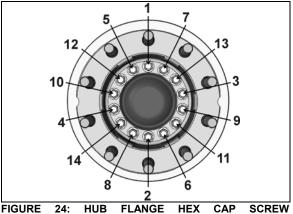
FIGURE 24: HUB FLANGE HEX CAP SCREW TIGHTENING SEQUENCE
