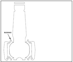
FIGURE 31: LOWER A-ARM BALL JOINT
