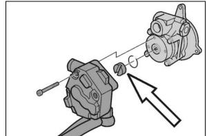
FIGURE 8: FUEL PUMP DRIVE AXLE
