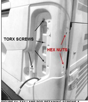
FIGURE 54: TAILLAMP POD RETAINING SCREWS & NUTS
