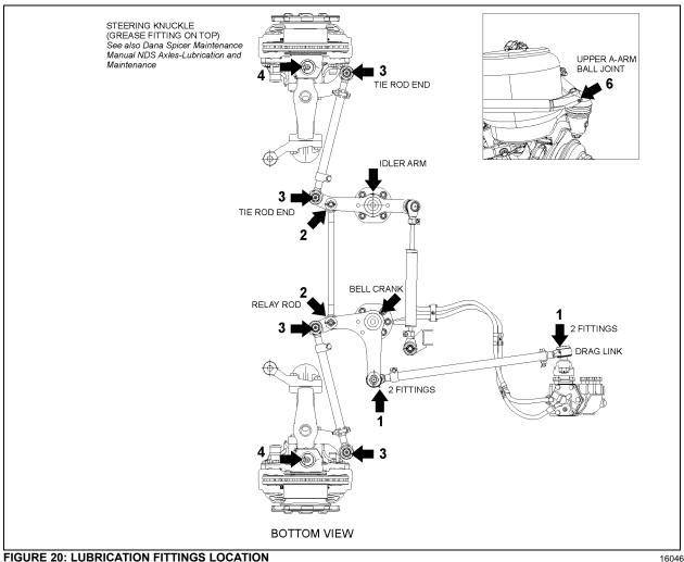
FIGURE 20: LUBRICATION FITTINGS LOCATION
