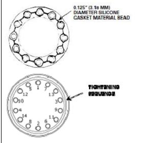
FIGURE 26: AXLE FLANGE TIGHTENING SEQUENCE
