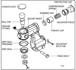
FIGURE 31: DROP TYPE BALL JOINT FOUND ON TIE ROD (2X)
