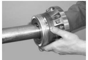
FIGURE 11: SLIP UNITIZED HUB BEARING OVER SPINDLE
