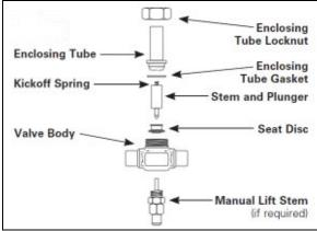
FIGURE 49: REFRIGERANT SOLENOID VALVE 22044
