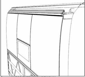
FIGURE 36 TOP EXTRUSION REMOVAL
