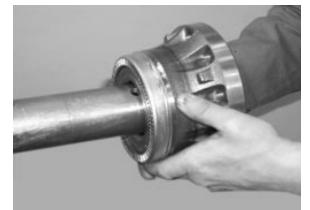
FIGURE 20: SLIDE UNITIZED HUB BEARING OVER SPINDLE
