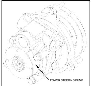
FIGURE 7: POWER STEERING PUMP
