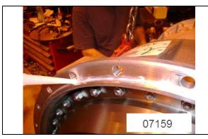
FIGURE 12: SILICONE APPLICATION TRANSMISSION HOUSING
