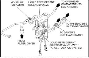
FIGURE 47: LIQUID REFRIGERANT SOLENOID VALVES INSIDE CONDENSER COMPARTMENT
