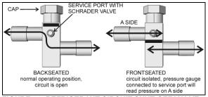
FIGURE 44: REFRIGERANT CIRCUIT SHUT-OFF VALVE
