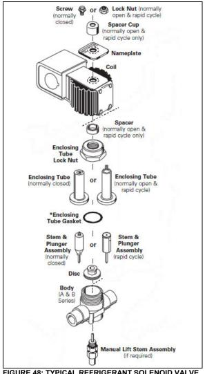
FIGURE 48: TYPICAL REFRIGERANT SOLENOID VALVE 22044
