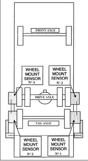
FIGURE 16: TAG AXLE ALIGNMENT
