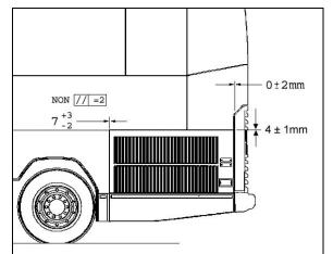
FIGURE 65: PROPER DOOR POSITIONING
