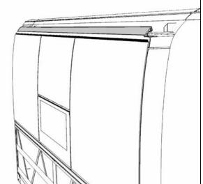
FIGURE 36 TOP EXTRUSION REMOVAL
