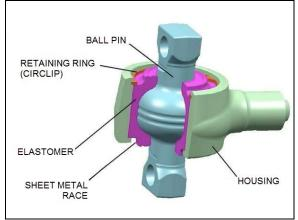
FIGURE 6: BALL PIN JOINT CONSTRUCTION 16186
