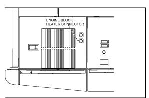
FIGURE 43: ENGINE BLOCK HEATER PLUG LOCATION
