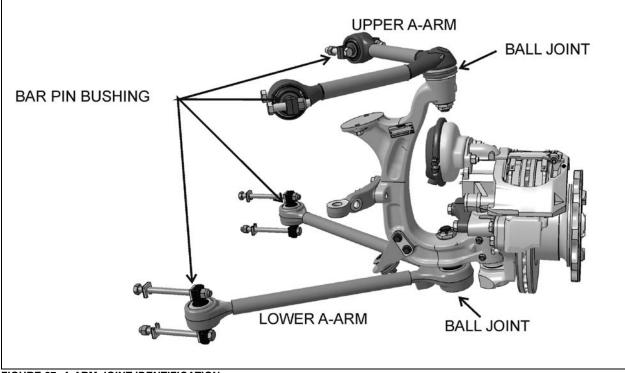
FIGURE 27: A-ARM JOINT IDENTIFICATION
