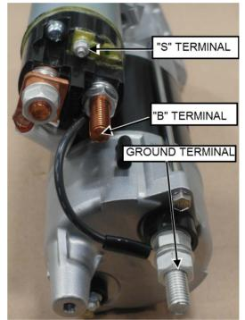
FIGURE 4 : TERMINAL IDENTIFICATION
