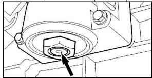
FIGURE 19: OIL FILTER HOUSING DRAIN PLUG
