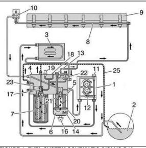
FIGURE 1: FUEL SYSTEM SCHEMATIC (VOLVO D13 ENGINE) 03086
