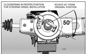
FIGURE 15: PROPER CLOCKSPRING POSITION
