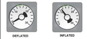
FIGURE 60: INFLATABLE SEAL PRESSURE GAGE
