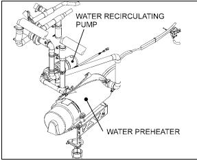
FIGURE 55: PUMP LOCATION – X3 SERIES CENTRAL A/C 22331
