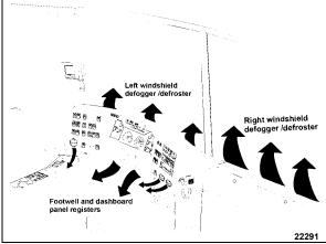
FIGURE 81: DRIVER'S UNIT AIR CIRCULATION
