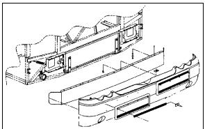
FIGURE 54: FRONT BUMPER REMOVAL
